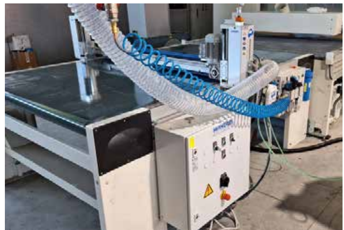
□ Konzolne čistilne krtače Wandres Una H-X 111 za čiščenje površin pri stranki Tehnomarket Pirić, Čelić, Bosna in Hercegovina
