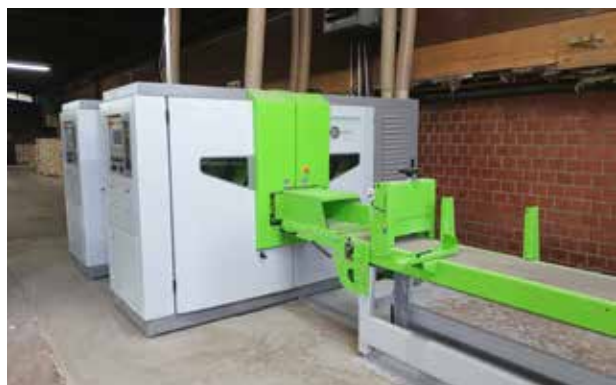
□ Tankorezni tračni žagi DSB Singlehead NG XM 350 pri stranki Drvoproizvod Jastrebarsko, HRV
