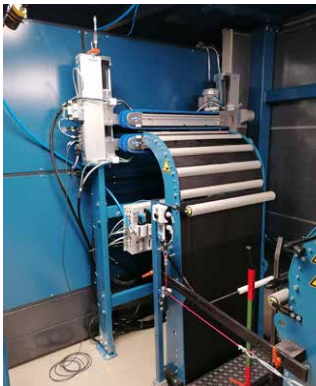
□ Konzolne krtače za čiščenje površin Wandres Una XL v rovarni Hidira Spodnja Kanomlja, Slovenija
