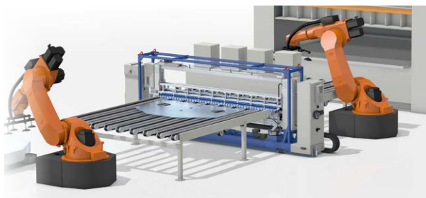
□ Evomat® za čiščenje štancanih elementov
