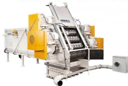
□ Model HZR 1300 je posebej prilagojen drobljenju debelostenskih cevi večjih premerov
