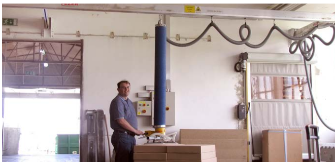
□ VacuPowerlift pri JERA-MIX-u, Begunje pri Cerknici, Slovenija
