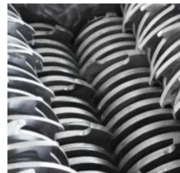
□ 2 rezalni in 2 čistilni gredi
