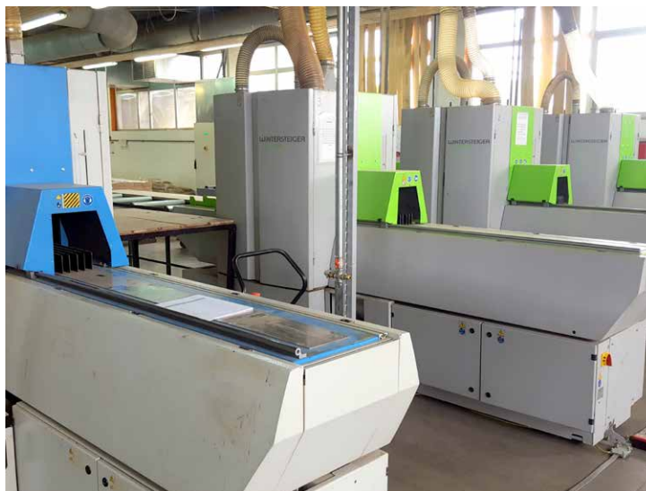
□ Mini gateri za rezanje lamela Wintersteiger DSG Sonic u tvornici Bjelin Bjelovar, Hrvatska
