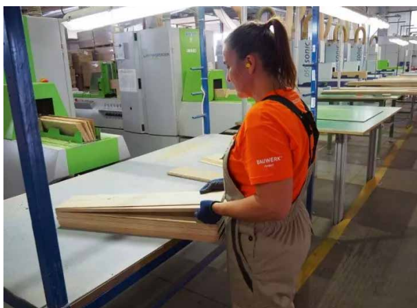
□ Linija od 6 mini gatera Wintersteiger DSG Sonic u Bauwerk Boen Group, Đurđevac, HRV
