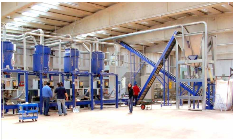
□ Primjer linije za izradu peleta velikog kapaciteta
