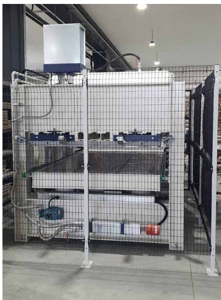
□ Membranska preša Air/System/Eco u tvornici TEHNOMARKET PIRIĆ, Čelić, BIH
