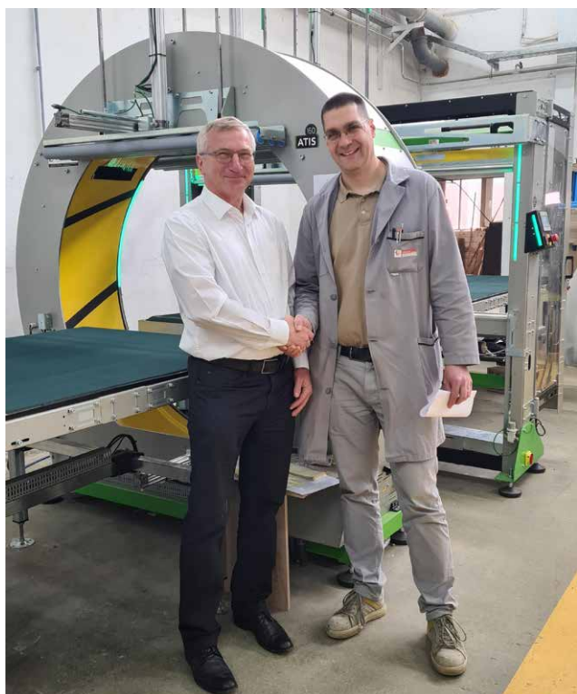
□ Automatski orbitalni stroj za omatanje folijom PLASTICBAND Atis u kombinaciji s dodavačem mjhuričaste folije Helios kod kupca MIZARSTVO FLORJANČIČ, Straža, Slovenija
