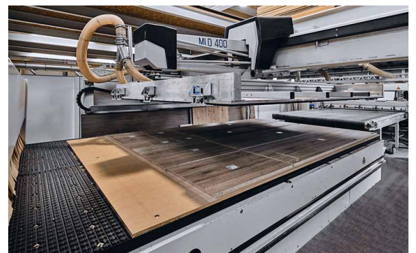
□ Automatsko skladište ploča Grundner MLD 300 i primjeri posluživanja krojača ploča i CNC strojeva.
