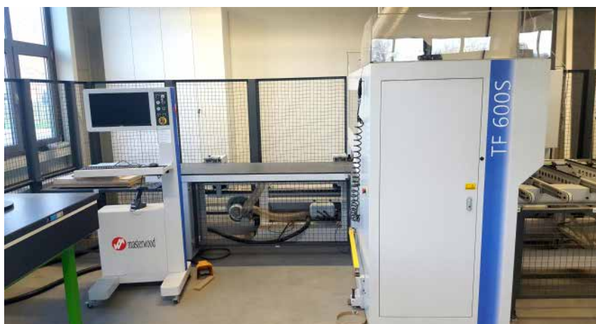
□ CNC protočni stroj za bušenje i glodanje Masterwood TF 600S u tvornici IVERPAN Zagreb, Hrvatska
