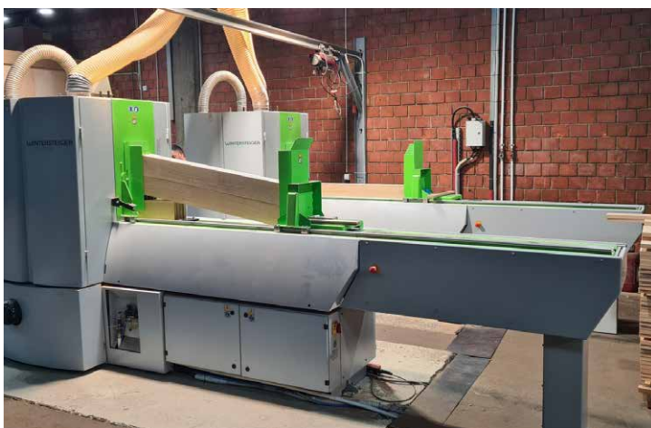
□ 2 mini gatera za rezanje lamela Wintersteiger DSG Sonic u tvornici Slabonija DI, Hrvatska
