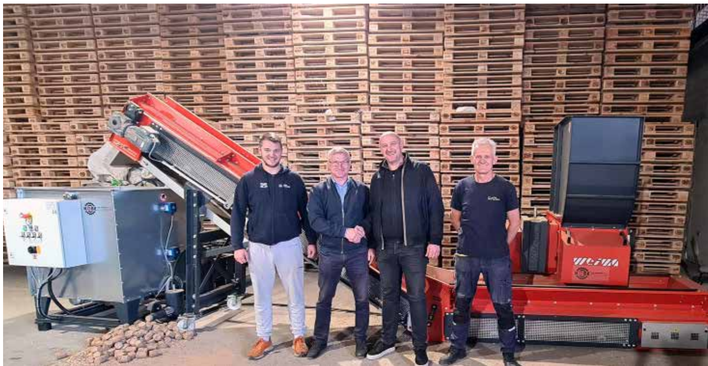
□ Reciklažna linija kod kupca D.N.T. Stiro Grupa d.o.o., Zagreb, Hrvatska , koja se sastoji od drobilice WLK 4 (za drobljenje drva, plastike, obojenih metala, stiropora, kartona i dr.), stroja za briketiranje C 150 te transportne trake s magnetom za izdvajanje metala.
