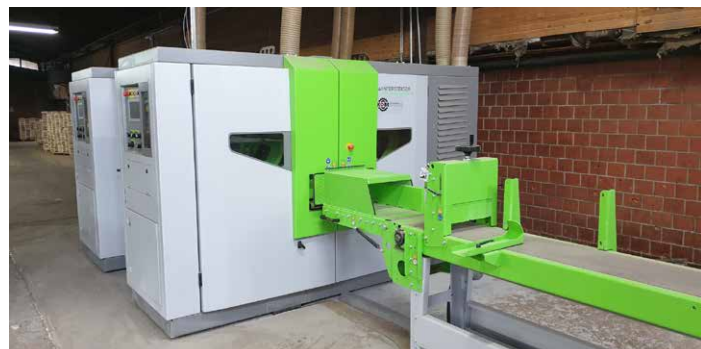
□ Linija za rezanje lamela sastavljena iz dva stroja DSB Singlehead NG XM 350 pri kupcu Drvoproizvod Jastrebarsko, Hrvatska
