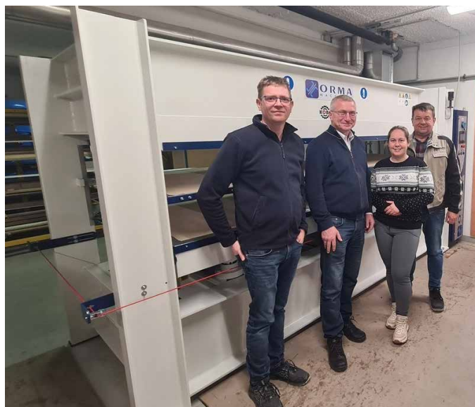
□ 2-etažna hidraulična preša NPC Digit 6-110 kod kupca KOVAČ GROUP, Novo mesto, Slovenija
