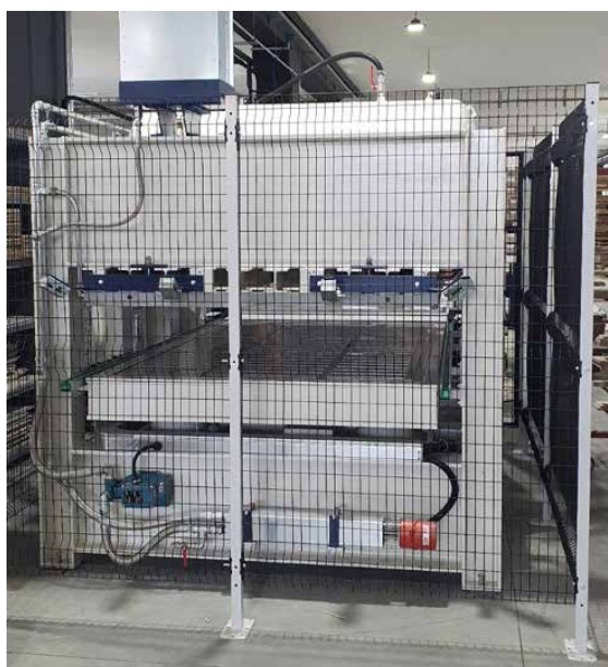
□ Membranska preša Air/System/Eco u tvornici TEHNOMARKET PIRIĆ, Čelić, BIH
