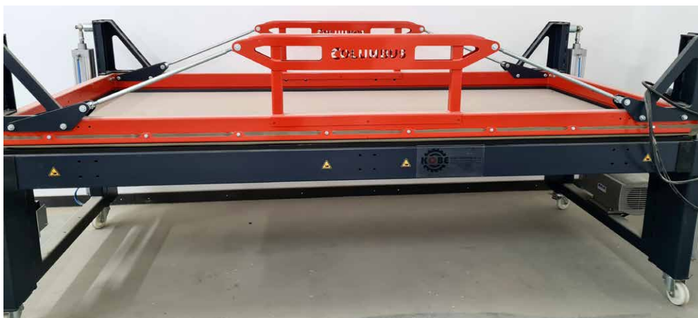
□ Vakuumska preša Columbus Pioneer Basic kod TGM LOGISTIKA, Žakanje, Hrvatska
