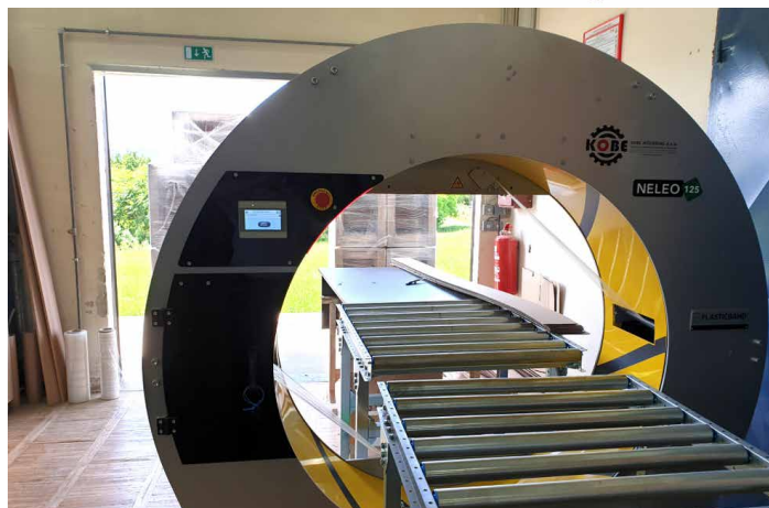
□ Stroj za omotavanje folije PLASTICBAND Neleo u tvornici KOVAČ INTERIER, Novo mesto, Slovenija
