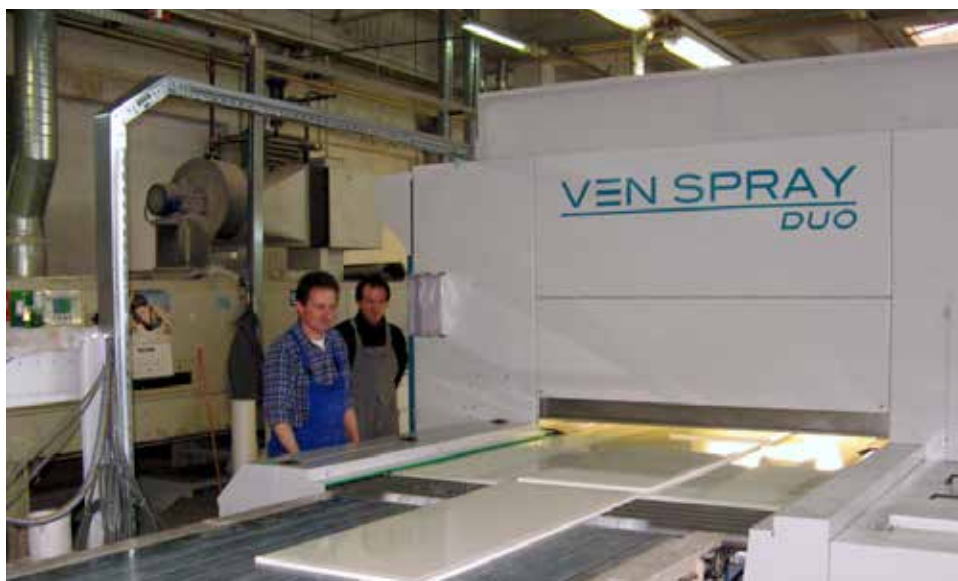
□ Stroj za brizganje laka Venjakob VenSpray DUO pri firmi JERAMIX, Begunje pri Cerknici, Slovenija
