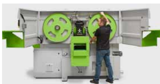
□ Konstrukcija stroja DSB Compact 310 omogoča postavitev dveh ali več strojev v liniji.
