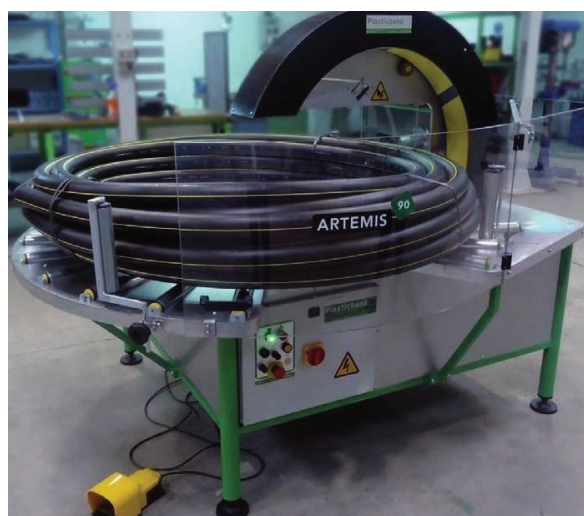
□ Model Artemis za ovijanje okroglih izdelkov s folijo
