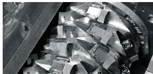
□ Stroj za drobljenje kovin, plastike in lesa Weima WLK 1000
