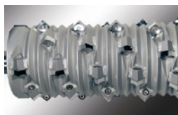
Na slici: drobilica WL 4 i V rotor s ugrađenim noževima
